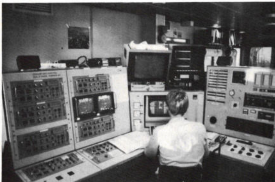
Survey-lessenaar op de brug van de Cadium. Links op de voorgrond bevinden zich de besturingseenheden voor de profielopnemers P1 t/m P7. Het middenconsole bevat het computerwerkstation en de besturingseenheid van het Honeywell RS904-USB-systeem, gebruikt voor het leggen van de kopbalk. In de rechter lessenaar zijn onder meer ondergebracht de standindicatoren voor de hellingmeters (linksboven), de moederklok (middenboven), een alarmpaneel en een gyrokompass-repeater.
