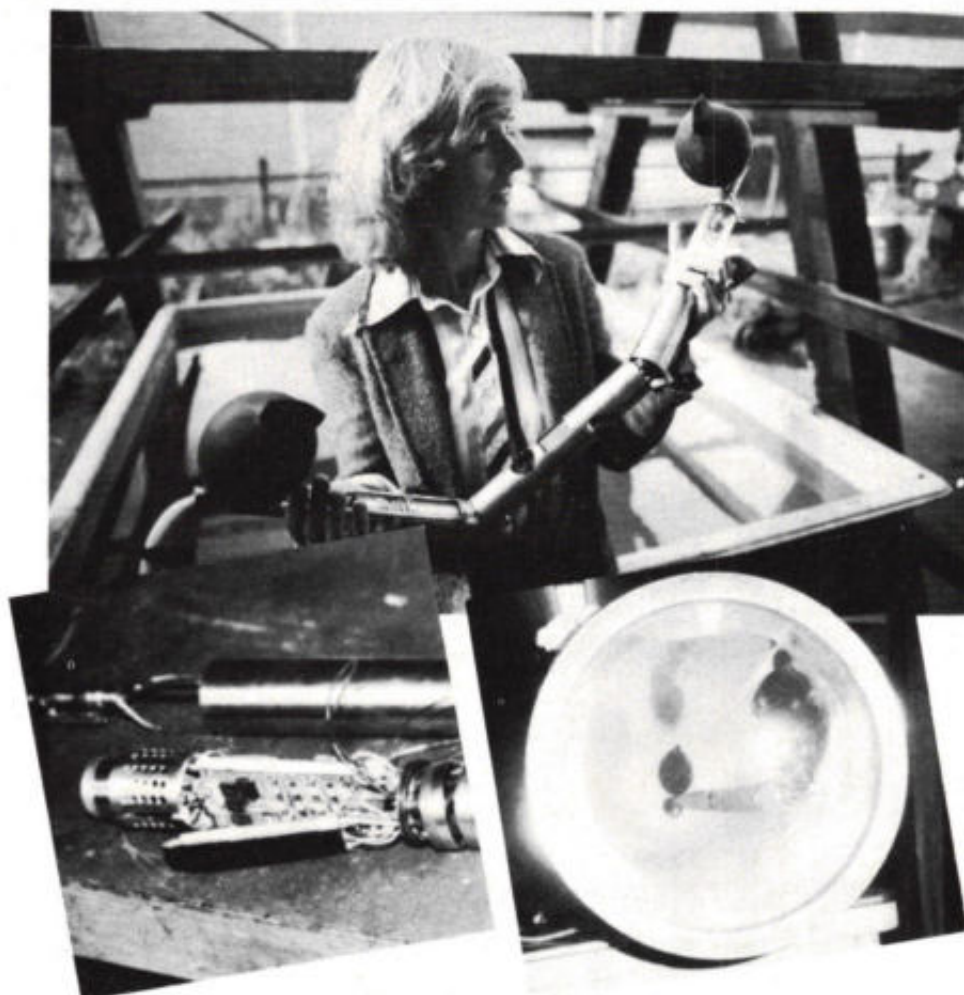
Fig. 13. De akoestische zandtransportmeter, een ontwikkeling van het Waterloorkundig Laboratorium (zie ook pag. 27).
