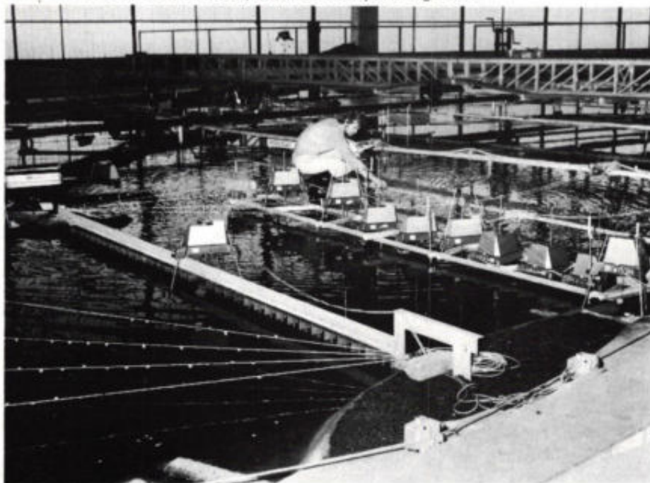
Detail van het Oosterschelde-model, waarin de Roompot is nagebootst.
