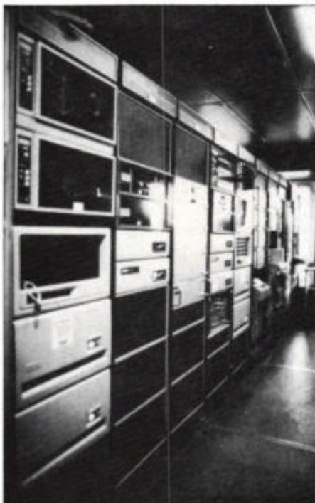
Computerruimte aan boord van de Cardium: een lange rij rekken met Digital PDP11-computers en bijbehorende geheugensystemen.
